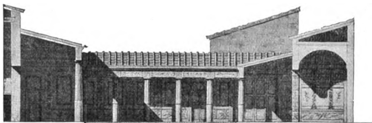
727. Rhodisches Peristyl, Durchschnitt (links die Südhalle, rechts die Exedra durchschnitten). Pompeji, Haus der silbernen Hochzeit
